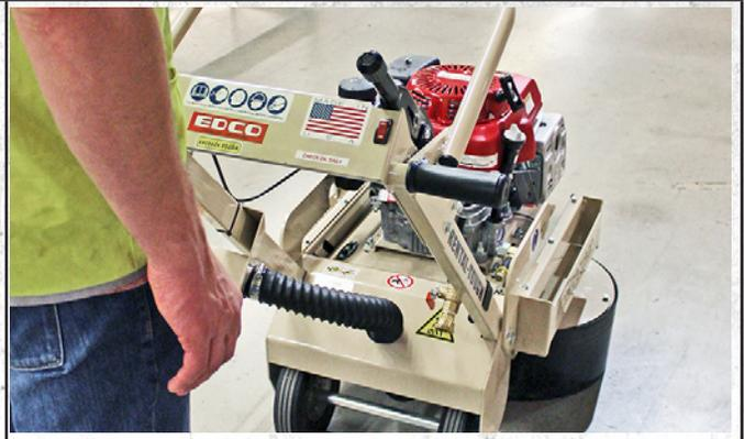
OPERATOR POSITION w/ DUAL-DISC GRINDER
